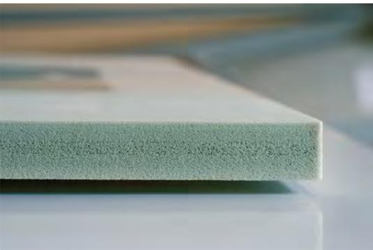
PET-Dämmstoff aus recycelten PET-Flaschen
